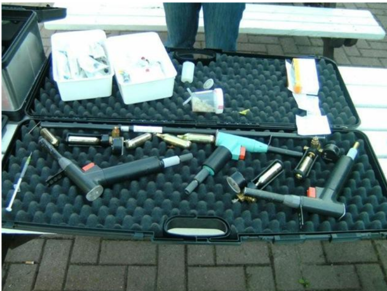
Fig. 65 Telinject pistool met CO 2 patronen (Baeten, 2010)
