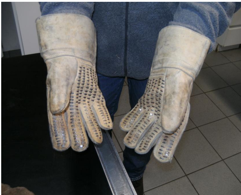
Fig. 46 Lederen handschoenen met stalen insteeksels (Baeten, 2010)
